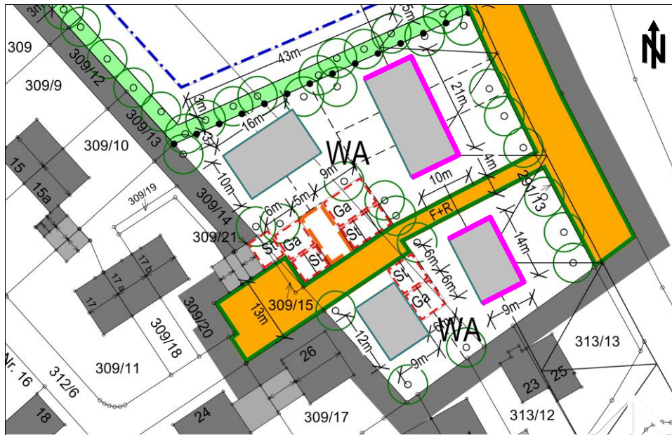
Abbildung 6. Kennzeichnung der Fassaden (pink), an denen in der Nachtzeit Beurteilungspegel > 49 dB(A) auftreten (auf Grundlage der Situation 1).
