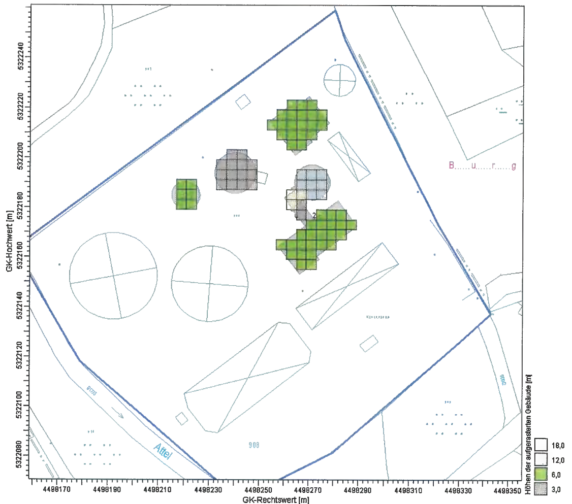
Abbildung 7. Gebäuderasterung für die Ausbreitungsrechnung
